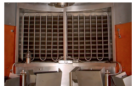
Schutzbaffle mit aufgesetzten Kühlleitungen
