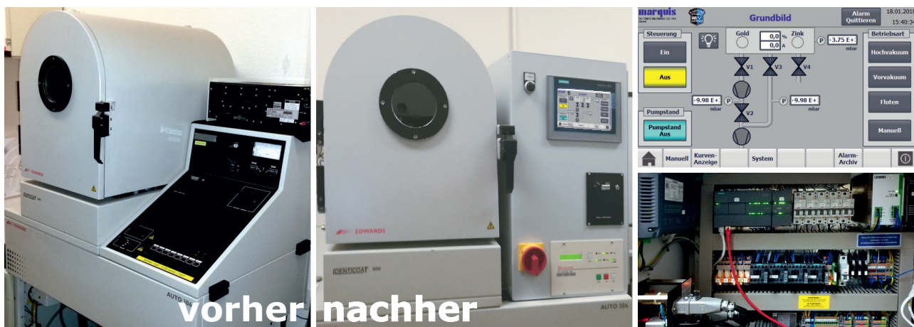
Beispiel Retrofit: EDWARDS IdentiCoat 500. Aufgrund des guten Anlagenzustandes, jedoch Probleme in der Steuerung, wurde hier die komplette Steuerung erneuert, die Vakuummeßtechnik ausgetauscht und die Anlage einer CE-Bewertung unterzogen.
